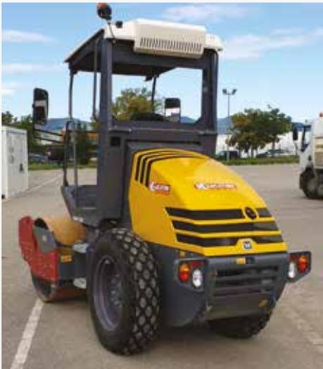
Rouleau 5 tonnes monocylindre V1 - V2
