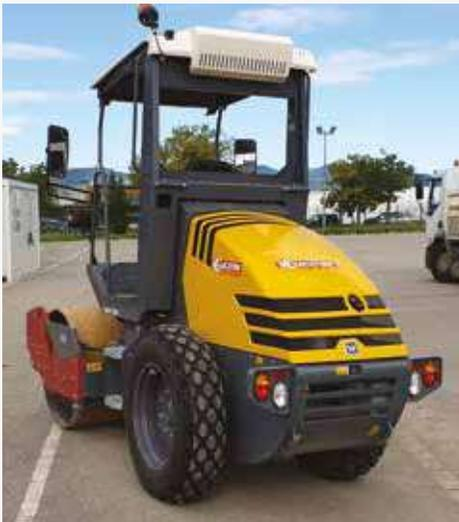
Rouleau 5 tonnes monocylindre V1 - V2
