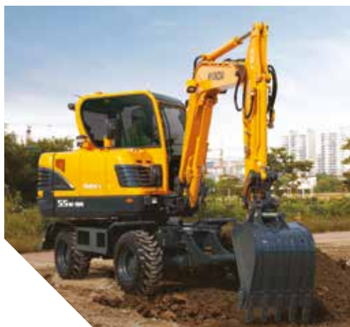
Pelle de 6 tonnes sur pneus
